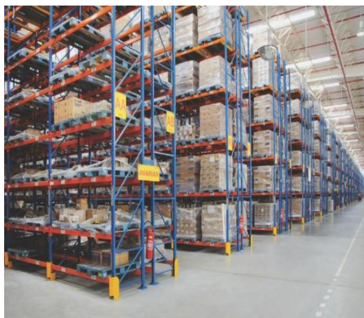
(b) Sistema de armazenamento em perfil Rack
