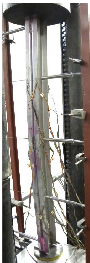
(a) Barra posicionada na máquina de ensaios
