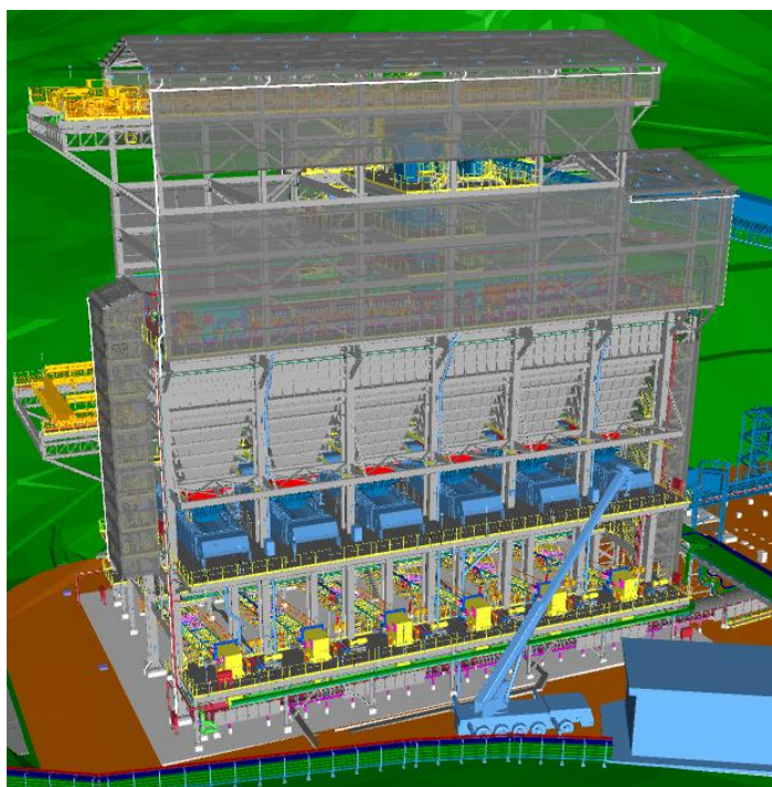
Figura 1- Modelo 3D do Prédio do Peneiramento Terciário
