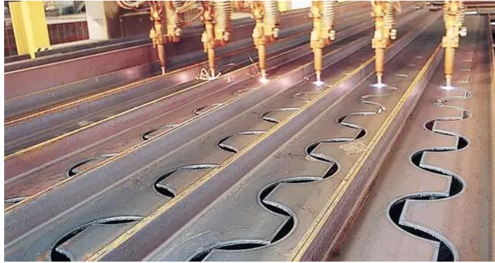
Figura 2 – Corte na alma para produção das metades de uma viga celular. (foto: ArcelorMittal Europa)
