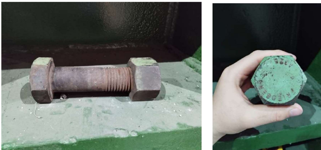
Figura 4 – Foto de um dos parafusos ASTM A325 de 1 ½” empregados na ligação do pilar com a viga do pórtico.
