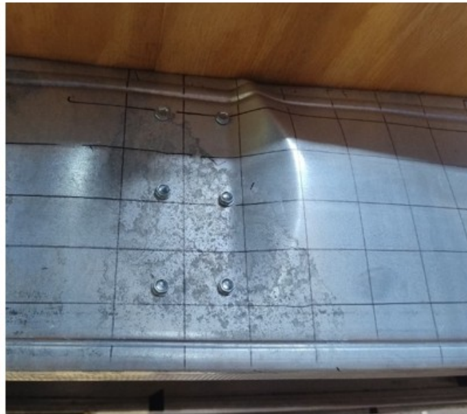
Flambagem local nos perfis do CP-A e CP-B da laje L-2
