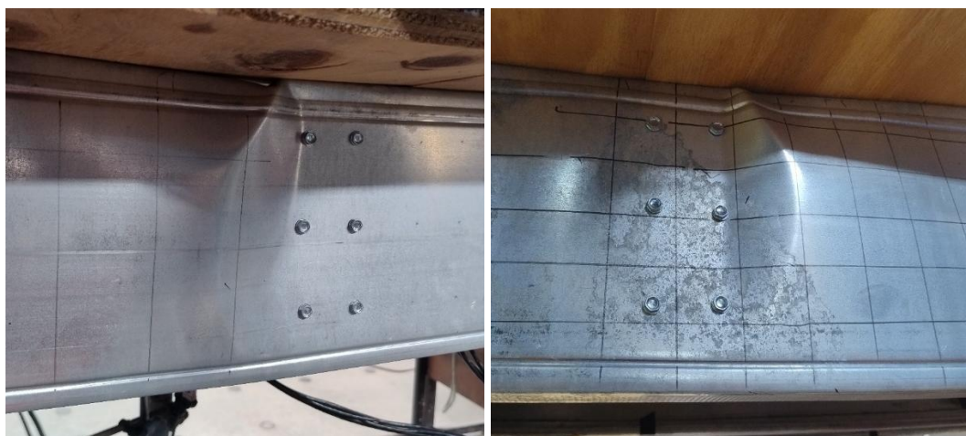
Figura 24 - Flambagem local nos perfis do CP-A e CP-B da laje L-2
