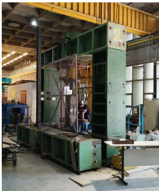
Figura 9 – Posicionamento do corpo de prova para o ensaio 4 (LINT): perfil CS 3120x125 com emendas por talas soldadas nas mesas e na alma, além de solda de topo, sem chanfro. As talas foram obtidas de um perfil HP 310x79 (aço ASTM A 572 Grau 50) – as dimensões do pórtico de reação estão indicadas em mm.
