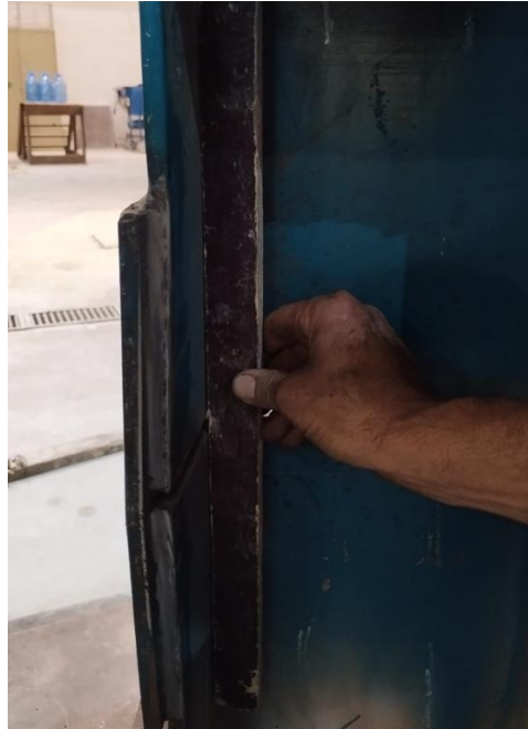
Figura 14 – Detalhe da flexo-compressão da tala após o ensaio 2.
