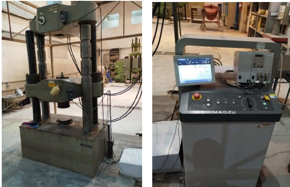
Figura 7 – Prensa Shimadzu UH-2000kN XR empregada para os ensaios 1 e 2 e equipamento conectado à prensa para aquisição de dados.
